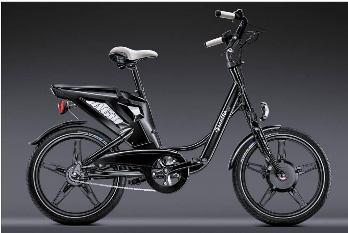
Disponible en roues de 20 pouces, le modèle **CX AGT** s'adresse plus spécifiquement aux jeunes urbains. Élégant et stylé avec ses roues à jantes aluminium, il dispose d'un équipement complet pour le confort et la sécurité. La position de conduite droite ainsi que la potence réglable sans outil garantissent des trajets sans fatigue. Les freins à disques hydrauliques assurent le meilleur niveau de sécurité.
