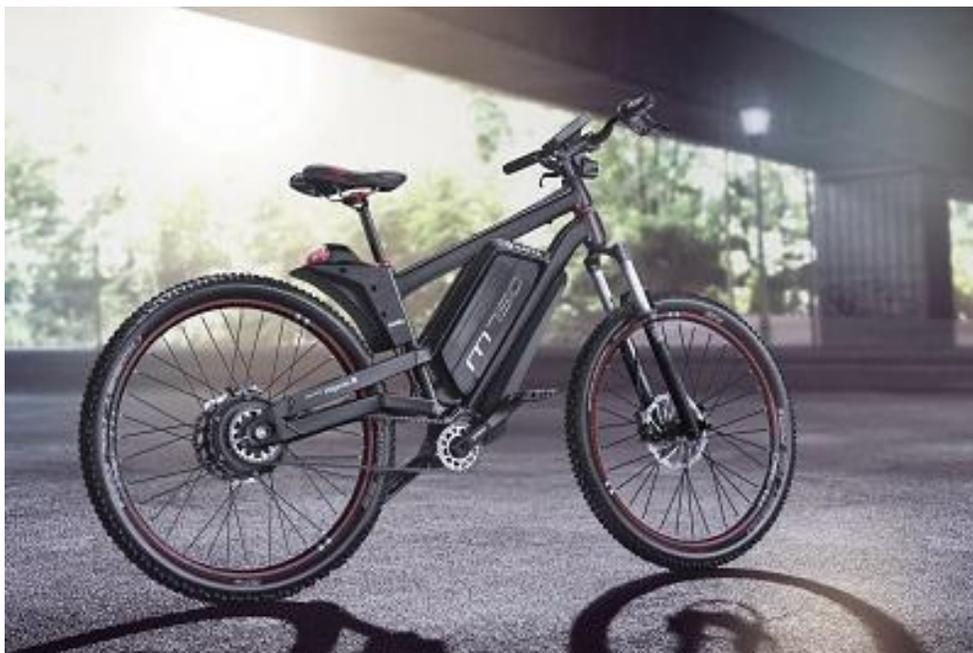
La passion et l'innovation des ingénieurs de MATRA ont permis de créer M750, un concept bike deux roues hybride humain électrique puissant et performant, alimenté par un moteur roue de 500W à technologie flux transversal, et d'un contrôleur refroidi par air. M750 est équipé d'une batterie lithium-ion « oversized » AllCell fabriquée en France, de plus de 700Wh. Cette batterie utilise la technologie AllCell PCM à refroidissement passif.
